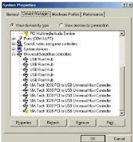
1. Asegúrese de que esta tarjeta PCI se ha instalado en su sistema correctamente. Abra el Administrador de dispositivos y compruebe si hay un signo de exclamación Amarillo junto a uno de los elementos “VIA Tech 3038 PCI a USB Universal Host Controller”.
