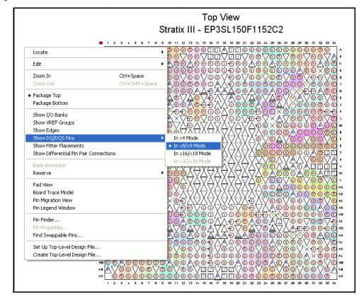
Figure 15. Quartus II Pin Planner, Show DQ/DQS Pins, In x8/x9 Mode
