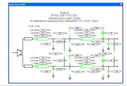
Figure 19. Stratix III Development Board DQS Signal Board Trace Model
