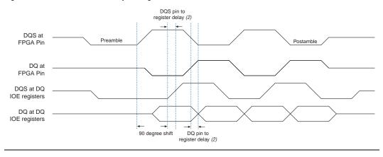
Figure 1. DQ and DQS Relationship During a DDR2 SDRAM Read in Burst-of-Four Mode
